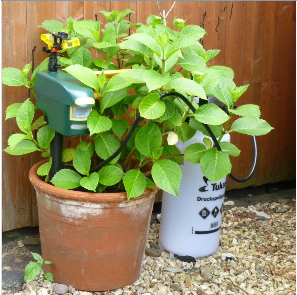
Auf dem Bild zu sehen ist der getarnte und akkubetriebene und mit Solarmodul und Bewegungsmelder ausgestattete Wassersprühapparat, sowie ein daran angeschlossenes und mit Wasser gefülltes Drucksprühgerät.
